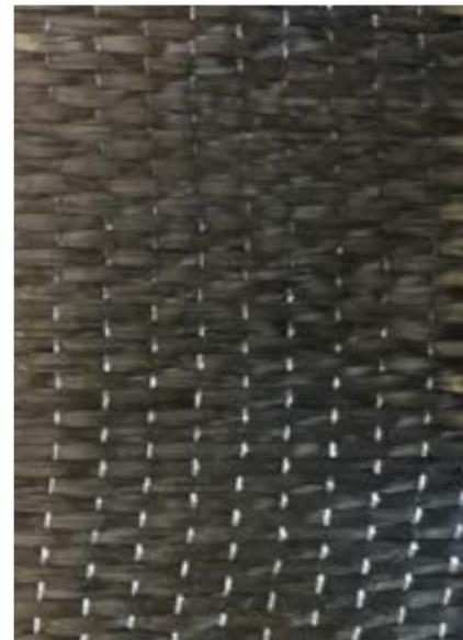
È un tessuto unidirezionale in fibra di carbonio ad alta resistenza. Il tessuto è termosaldato mediante un termofilato in trama per garantire ottima stabilità di posa e lavorabilità in cantiere, mantenendo un perfetto allineamento delle fibre. Il tessuto è in fibra secca applicabile con matrice organica per la realizzazione del sistema **CARBO-STRUCTURA** in composito FRP classe 210C avente CIT n. 492/2017.
