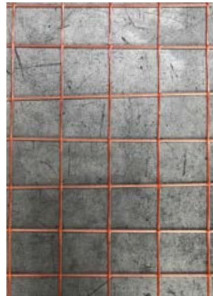
È una rete in materiale composito (Glass Fiber Reinforced Polymer) alcali resistente.
