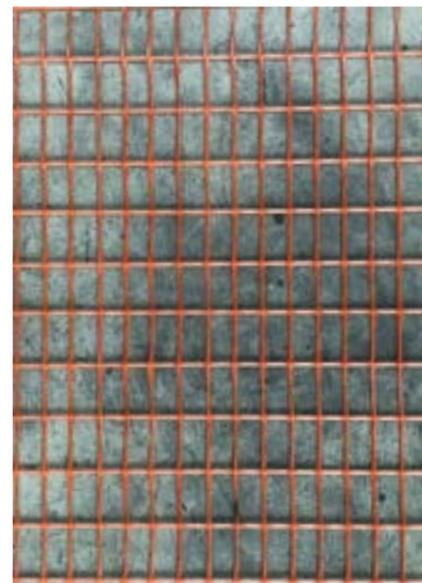
È una rete in materiale composito (Glass Fiber Reinforced Polymer) alcali resistente.
